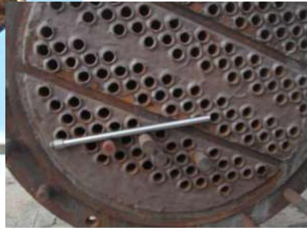
O ATCS da C.Q.M foi instalado em Outubro de 2003, durante uma parada de manutenção planejada. Antes da instalação do ATCS, o condensador foi limpo com ácido e água à alta pressão.
